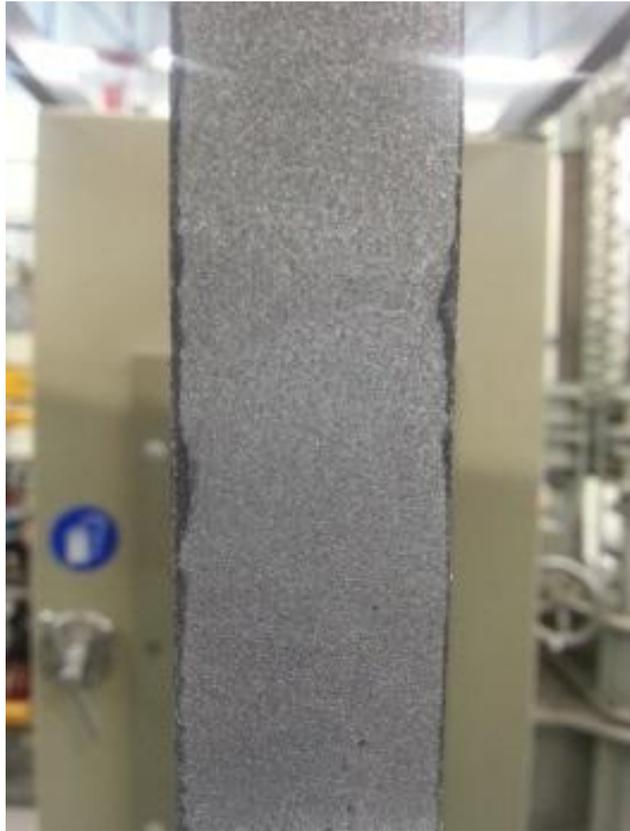
Figura 21: Corpo de prova ensaiado após trinta dias em condições salinas [fonte: própria]
