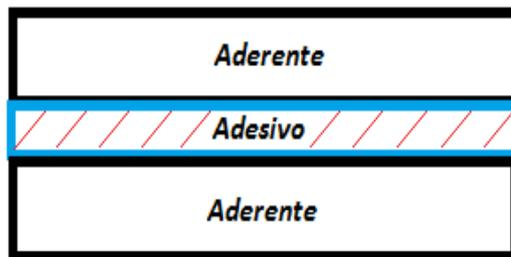
*Ruptura coesiva no adesivo*
