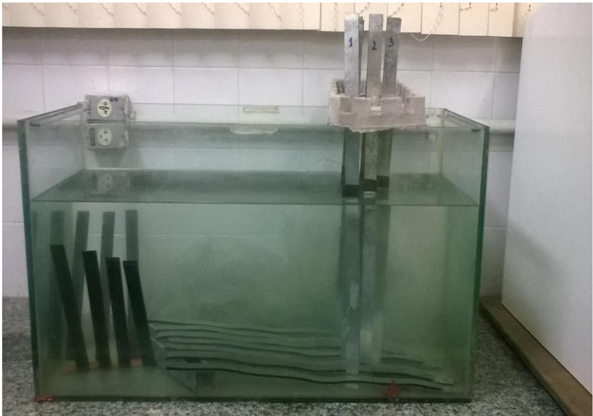
Figura 22: Corpos de prova em processo de envelhecimento no LADES [fonte: própria]
